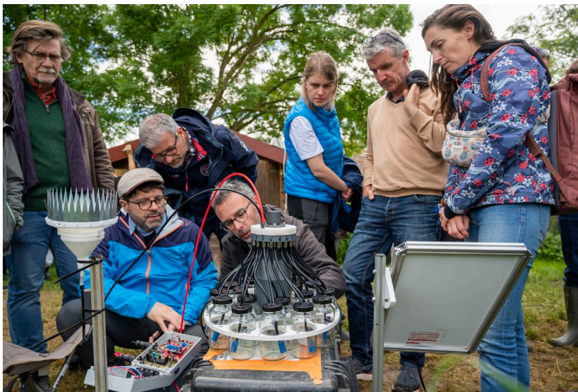
Démonstration d'un échantillonneur automatique pour l'étude fréquentielle des isotopes de l'eau de pluie sur le site Bassin Versant Expérimental Agricole de Montoussé à Auradé (BVEA)
