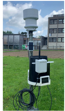
Nœuds LoraWan de pluviomètres à auge Campus de Beaulieu Rennes
