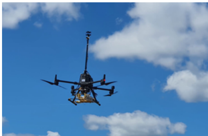
Figure 1 : Photo du système de mesure de CO 2 /CH 4 couplé à un capteur vent.
